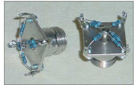
Bild 13: Selbstgebaute 50\text{-}\Omega -Abschlusswiderstände mit N-Buchse
