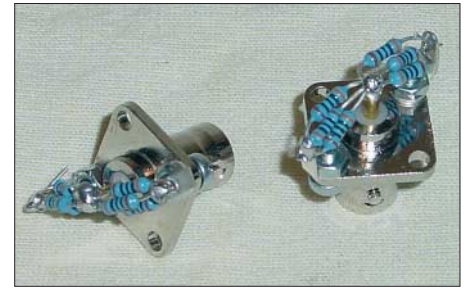
Bild 14: Abschlusswiderstände auf BNC-Basis Fotos und Screenshot: DK7ZB
